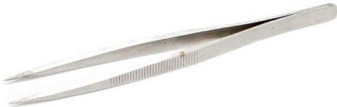
Пинцет используется при пайке СМДшек, для ковыряния платы, удаления полипов флюса. Пока он был острым, я даже умудрялся с его помощью дорожки перерезать.
