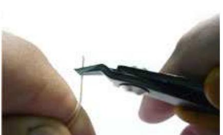
Бокорезы незаменимый и ходовой инструмент в хозяйстве электронщика. Используются для обрезания проводов, ножек радиоэлементов, снятия изоляции и маникюрных
