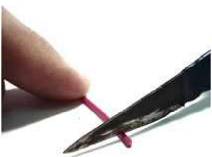
Небольшой нож с тонким и острым лезвием должен быть в арсенале каждого электронщика. Многие (и в том числе я) делают такой нож из куска испорченного ножовочного полотна. Таким ножом можно перерезать дорожки на печатной плате, отрезать ножки микросхем, предназначенных для демонтажа, обрезать и
