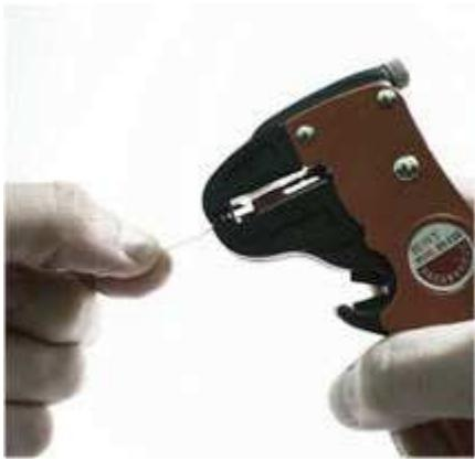
Ну и, наконец, изоляцию с проводов можно снимать специальным инструментом – стриппером. (англ. wire stripper). Существует несколько разновидностей стрипперов, я вот, например, пользуюсь тем, который изображен на фотографии. Это так называемый автоматический стриппер.
