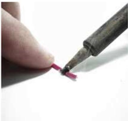
С помощью паяльника можно снимать изоляцию с проводов в поливинилхлоридной оболочке. Кладем провод на горизонтальную поверхность, придавливаем его нагретым жалом паяльника и проворачиваем. Изоляция в месте соприкосновения с жалом выгорит и ее можно будет легко снять пальцами, пинцетом или плоскогубцами.
